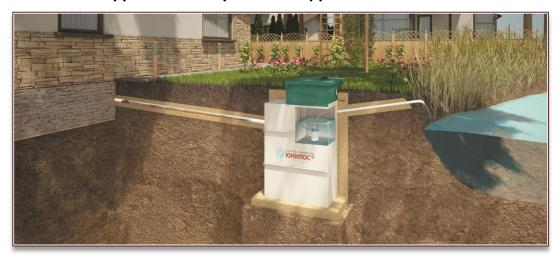
Рекомендуется в грунтах с низким коэффициентом фильтрации — глина, суглинок. Отвод производится на рельеф местности (водоотводная канава, ливневая канализация).
