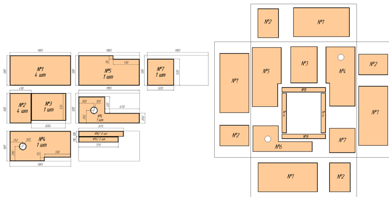
Рисунок 7 – Карта раскроя утеплителя
