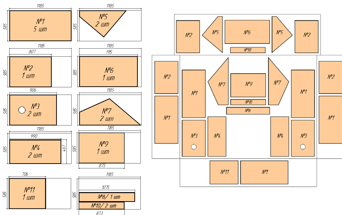
Рисунок 7 – Карта раскроя утеплителя
