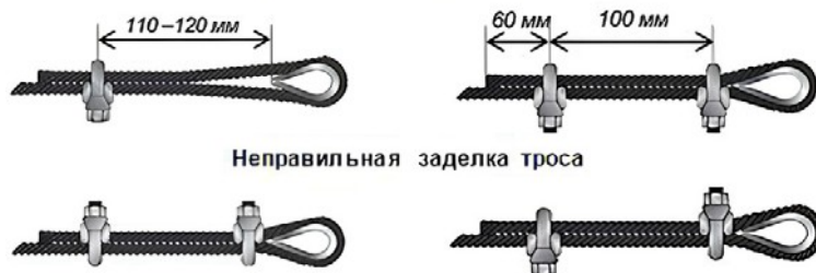
Рисунок 6 – Заделка троса
