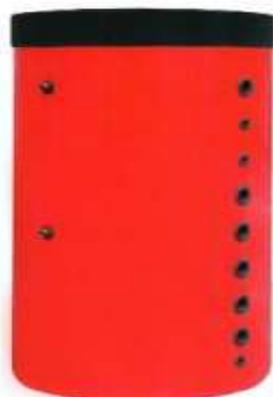
Изоляция бака выполнена по технологии NOFIRE из полиэфирного материала толщиной 70 мм с высоким классом огнестойкости класса B-s2d0 в соответствии с Европейскими Требованиями EN 13501. С наружной стороны бак защищен легкой и прочной металлической изоляцией с окрашенной
